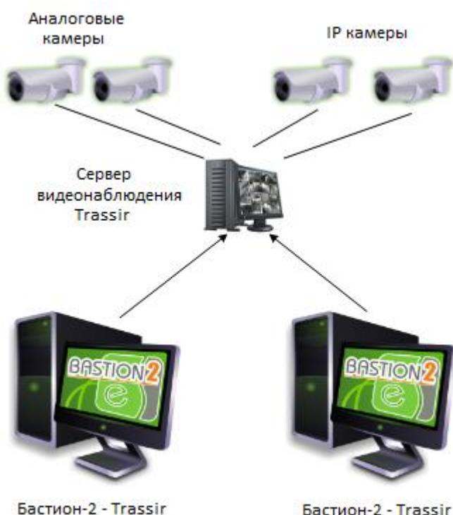
Рис. 1 – Схема работы драйвера «Бастион-2 – Trassir»
