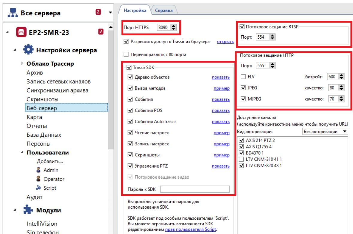
Рис. 2 – Предварительная настройка сервера «Trassir»
