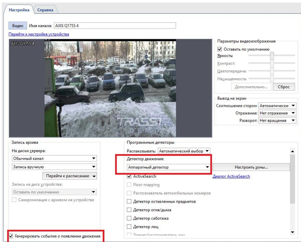
Рис. 11 – Настройка детектора движения
